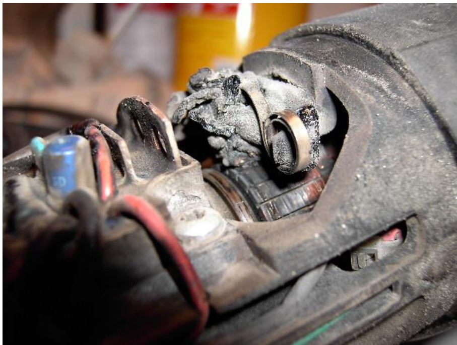
Bild: Betongslip LD15-10. Sliten kollektor med igensatta kol.
