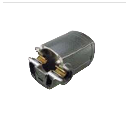
FLEX MVG-METALLHUS Utvändigt värmebeständigt lättmetallgods. Invändigt en högisolering plast för elektrisk säkerhet och dämpad ljudnivå. Massiva kolhållare i mässing för snabb värmeavledning. Vinkelslipen L 2106VC/L 2108 VC ► sid 14
